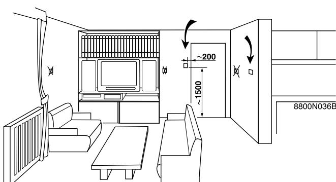
Zdalne sterowanie należy instalować na ścianie wewnętrznej na wysokości około 1.5 m od podłogi w miejscu starannie do tego celu wybranym.
