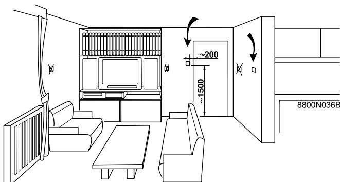
O controlo remoto deverá ser instalado numa parede interior, a cerca de 1.5 m do chão na divisão-piloto cuidadosamente seleccionada.
