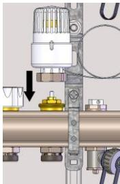
Installazione della testa termostatica per punto fisso:
