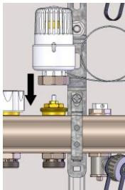
Установка термоголовки с фиксированной температурой на подаче:
