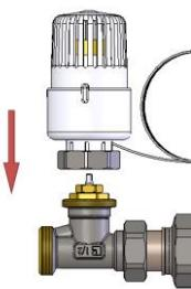
Installazione della testa termostatica per punto fisso:
