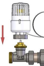
Установка термоголовки с фиксированной температурой на подаче:
