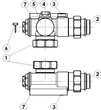
**1) Накидные гайки G 1 "1/2 для подключения циркуляционного насоса**
