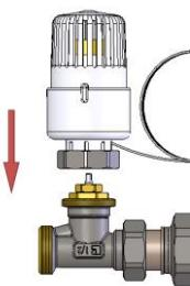
Instalación del cabezal termostático para punto fijo:
