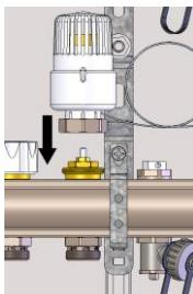
Instalación del cabezal termostático para punto fijo:
