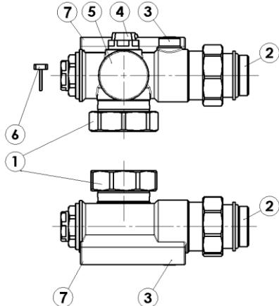
**1) Raccordi da G 1"1/2 per il collegamento della pompa di circolazione.**
