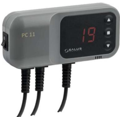
Paredzēts, lai kontrolētu ūdens sūknī centrālās apkures kontūrā. Ierīces uzdevums ir sūkņa ieslēgšana, ja temperatūra pārsniedz vēlamo vērtību, un izslēgšana, ja katls atdziest (sakarā ar izslēgšanu). Tas novērš nevajadzīgu sūkņa darbību un pagarinā tā kalpošanas laiku, kas ļauj ietaupīt elektrību.
