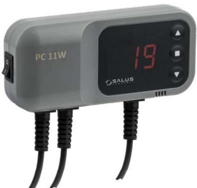
Paredzēts, lai kontrolētu ūdens sūknī centrālās apkures vai karstā ūdens kontūrā. Darbojas arī kā drošības termostats. Tam ir iespēja ieslēgt un izslēgt sūknī. Sūknis darbosies pēc tam, kad būs pārsniegta lietotāja iestatīta temperatūra "C", un izslēgsies, kad būs pārsniegta iestatīta izslēgšanas temperatūra "U".
