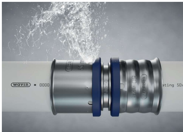
16.att.: DEFINED LEAK funkcija: spiediena pārbaudes laikā no nenopresētā veidgabala tek ūdens.
