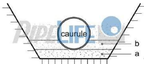
Caurules drīkst ieguldīt tieši uz nolīdzinātas tranšejas pamatnes (attiecīgi pamatnes konstrukcijas 2. un 3. tips attēlā zemāk), nodrošinot caurulēm atbalstu visā tās garumā, ja grunts ir vienveidīga, relatīvi mīksta un graudaina. Augšējā izlīdzinošā slāņa biezumam (b) ir jāatbilst būvprojektā norādītajām prasībām.
