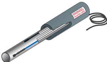
**Установка на водопроводной трубе**
