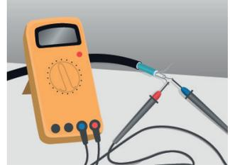
3. Kontrollér varmekablerens isolationsmodstand. Den målte værdi skal være mindst 50 MΩ.
