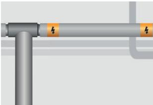
10. После выполнения изоляции нанесите предупредительную маркировочную ленту на изоляционную оболочку или каналы для труб через каждые 5 м. При установке кабеля не на поверхности необходимо проложить защитную ленту с предупреждающим знаком на 10 см выше кабелей.
