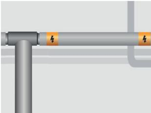
10. Laita eristyksen jälkeen turvamerkinnot viiden metrin välein eristevaippaan tai putkikouruun. Maan alle asennettaessa on laitettava peitenauha ja varoitusmerkki 10 cm kaapeleiden yläpuolelle.
