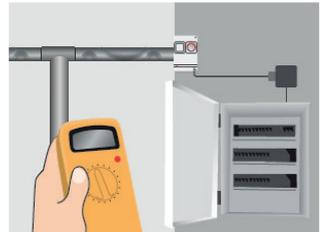
9. Выполните повторную проверку сопротивления изоляции. Подключите кабели к распределительным коробкам и к распределительному щиту.
