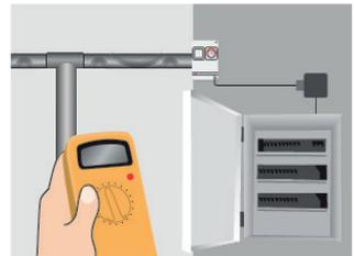
9. Kontroller isolasjonsmotstanden på nytt. Koble kablene til koblingsbokser og til brytertavle.
