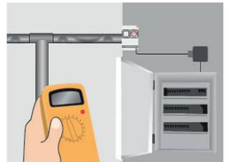
9. Tarkista eristysvastus uudelleen. Kytke kaapelit kytkentärasioihin ja sähkökeskukseen.
