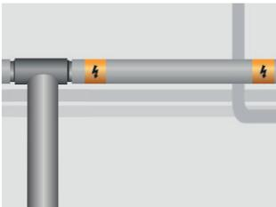
10. Efter isolering ska märktejp placeras på isoleringsmanteln eller rörrännorna var 5:e meter. Vid installation under mark ska täckband med varningsskylt läggas 10 cm över kablarna.
