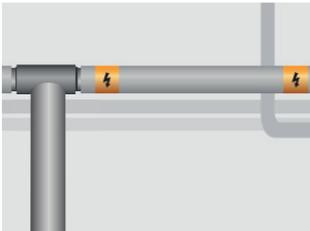
10. Pärast isoleerimist tuleb isolatsioonikestale või torusüvenditesse paigaldada iga 5 m järel märgistusteip. Pinnasealuste paigaldiste korral tuleb kaablitest 10 cm jagu kõrgemale asetada hoiatussildiga kattelint.
