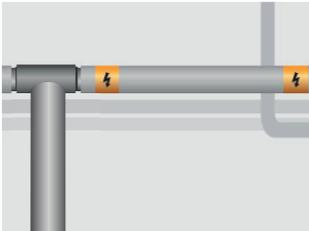
10. Sumontavę priklijuokite saugos markavimo juostą ant izoliacijos korpuso ar vamzdžio kanalo kas 5 m. Jeigu montuojama po pagrindu, virš kabelių kas 10 cm būtina naudoti dengiamąją juostą su įspėjamuoju ženklu.
