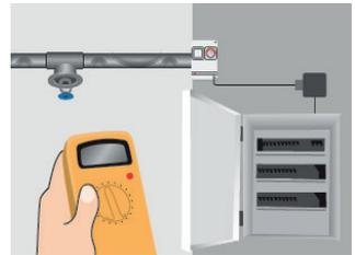
9. Kontrollér isolationsmodstanden igen. Tilslut kabler til tilslutningsboks og til eltavlen.
