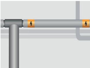
10. Etter isolering plasseres merketape hver 5. m på isolasjonsskappen eller rørgatene. I installasjoner under bakken skal det legges et dekkbånd med advarselsskilt 10 cm over kablene.
