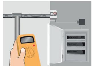
9. Kontrollera isoleringsmotståndet igen. Anslut kablarna till kopplingsdosor och till reglercentralen.
