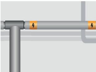
10. Pēc izolēšanas ik pēc 5 m piestipriniet drošības marķējuma lenti uz izolācijas apvalka vai cauruļu tranšejas. Pazemes instalācijas gadījumā 10 cm virs kabeļiem ir jāiekļāj noseģlenta ar bridinājuma zīmi.
