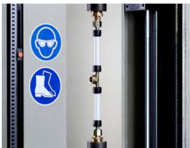
TECElogo-Ax izraušanas testā: testēšana notiek sistēmā.
