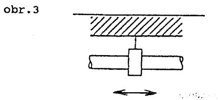
Augstāk aprakstītos kompensatorus var izmantot horizontāliem un vertikāliem cauruļvadiem. Ja cauruļvads tiks novietots zem apmetuma, šos kompensatorus lietot nedrīkst. Šādā gadījumā lineāro pagarinājumu kompensēs cauruļvada viļņainums.
