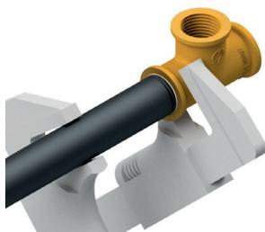
Collegare il raccordo con il circuito facendo attenzione a non eccedere con il serraggio del pezzo. Verificare la filettatura del raccordo e inserire il tubo per la lunghezza massima pari alla filettatura, senza provocare deformazione del raccordo.
