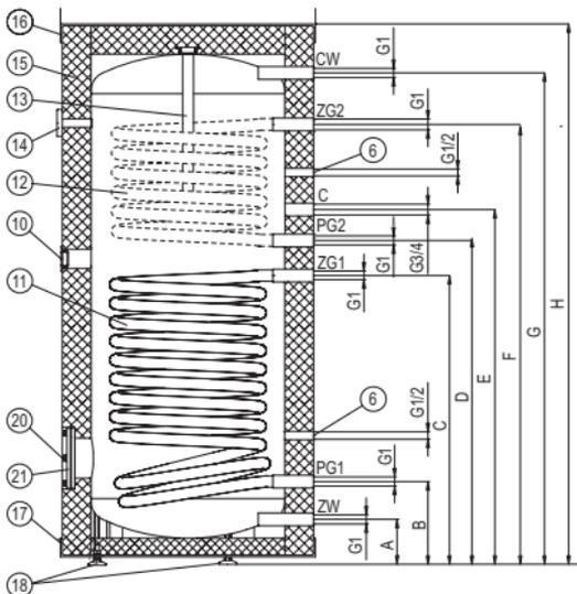
**Верхний змеевик (патрубки ZG2, PG2) и верхняя гильза датчика есть только в моделях SB и SBZ.**
