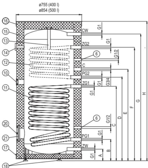
**Augšējais siltummainis (vītņu atvērumi ZG2, PG2) un augšējā devēja čaula ir tikai modeļiem SB un SBZ.**
