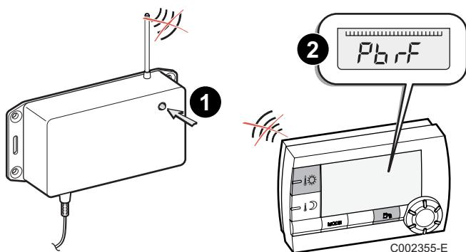
**1** In geval van problemen dooft het lampje na 2 minuten en geeft de afstandsbediening het bericht **Pb rF** weer.
