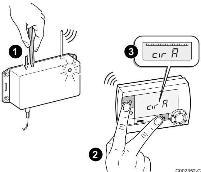
**1** Druk op de drukknop van de radiomodule met behulp van de punt van een pen. Het lampje van de radiomodule gaat branden.
