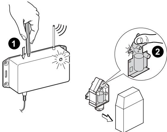
Każdemu czujnikowi temperatury zewnętrznej przydzielono w fabryce unikalny numer identyfikacyjny, który umożliwia rozpoznanie go przez moduł radiowy. Ten numer identyfikacyjny jest przesyłany do modułu radiowego poprzez sekwencję kojarzenia opisaną poniżej.
