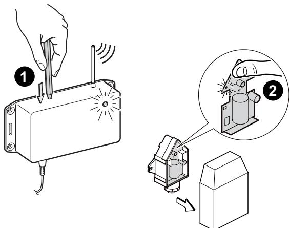
**1** Apretar el pulsador del módulo de radio usando la punta de un bolígrafo o similar. Se enciende el piloto del módulo de radio.
