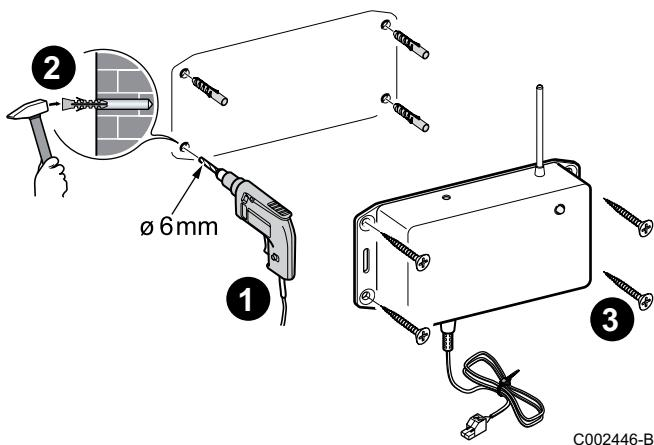
Il modulo radio deve essere fissato al muro nelle vicinanze del generatore di calore per consentire il collegamento al quadro di comando di quest'ultimo. Utilizzare le 4 viti + 4 tasselli consegnati.
