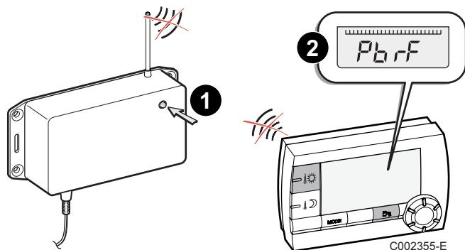
**1** Im Fall von Problemen verlischt die Leuchte nach 2 Minuten, und an der Fernbedienung wird die Meldung **Pb rF** angezeigt.
