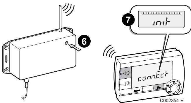
**6** **7** Na enkele seconden gaat het lampje van de radiomodule uit en toont de afstandsbediening het bericht "init", zolang het synchroniseren met de module bezig is.
