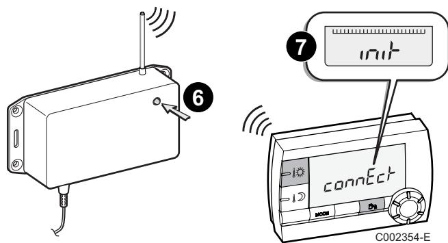
**6** **7** Dopo qualche secondo, la spia del modulo radio si spegne e il comando a distanza visualizza il messaggio "attivaz." durante la sincronizzazione con il modulo.
