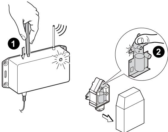
Iedere buitensor heeft standaard een uniek identificatienummer waarmee de radiomodule deze herkennen kan. Dit identificatienummer wordt aan de radiomodule doorgegeven door de hierna beschreven combinatiesequentie.
