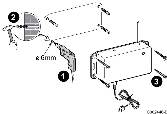
Le module radio doit être fixé au mur à proximité du générateur de chauffage pour permettre le raccordement dans le tableau de commande de ce dernier. Utiliser les 4 vis + 4 chevilles livrées.
