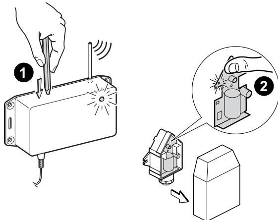
Каждый датчик наружной температуры имеет уникальный идентификационный номер, который позволяет радиопередатчику распознавать его. Этот идентификационный номер передается радиопередатчику во время цикла настройки радиопередачи, описанного далее.
