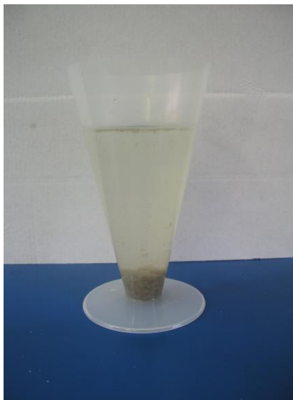
Imhoffa konusā notekūdens pēc 30 minūšu nostādināšanas (pārāk zems dūņu koncentrācija)
