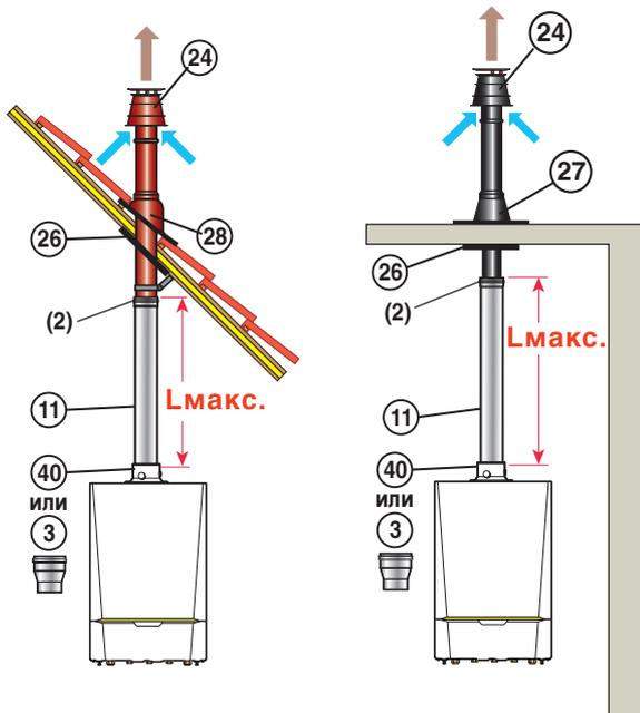
На рисунке показан котёл MCA с вертикальным коаксиальным дымоходом  $\varnothing 80/125$  мм (ед. поставки DY 843) + Переходник  $\varnothing 80/125$  мм (ед. поставки HR 38)
