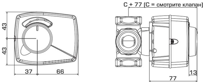
Размеры установки для приводов серии АРА600 со смесительными клапанами ESBE VRG100, VRG200, VRG300 и VRB100
