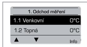
Měření" zobrazuje na displeji aktuálně naměřené teploty.
