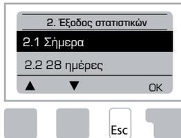
Έλεγχος λειτουργίας του συστήματος με τις ώρες λειτουργίας, κλπ.
