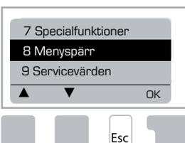
Menyspärren kan användas för att skydda regleringen mot oavsiktlig ändring och äventyrande av grundfunktioner.
