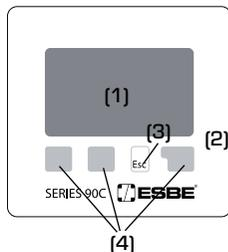
Wyświetlacz (1) z rozbudowanym trybem tekstowym oraz graficznym jest czytelny i umożliwia łatwą obsługę regulatora.
