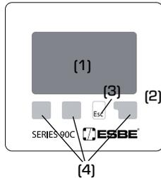
Die Anzeige (1) ist mit ihrem umfassenden Text- und Grafikmodus nahezu selbsterklärend und ermöglicht einen einfachen Betrieb des Reglers.
