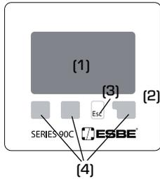
Afișajul (1), cu modul său extensiv de text și grafică, este aproape întotdeauna auto-explicativ, permițând utilizarea simplă a servoregulatorului.
