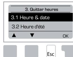
Heures de fonctionnement du circuit de chauffage et de l'eau chaude Mise à l'heure de l'horloge.
