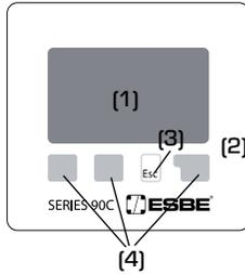
Laajassa näytössä [1] on tilaa selkeille teksti- ja kuvaohjeille, mitkä helpottavat lämmönsäätimen käyttöä.
