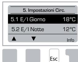
Impostazione dei parametri per il circuito di riscaldamento
