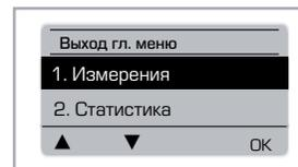
Меню закрывается нажатием "esc" или выбором "Exit measurements" (Закончить измерения).
