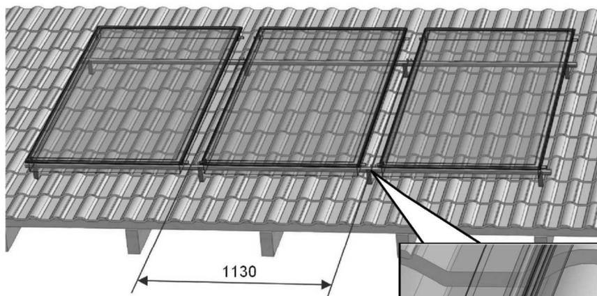
Между коллекторами предусмотрена установка двух зажимов коллектора (3), которые устанавливаются при помощи крепежных болтов (6), а на концах комплекта устанавливаются еще по одному зажиму коллектора (3). Боковые крепежные болты (6), которые служат для установки зажимов
