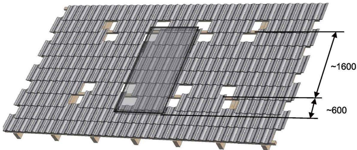
В обозначенных местах при помощи шурупов  $\varnothing 6 \times 40$  прикрепить равномерно расположенные кронштейны (2), соблюдая между ними расстояние „А”.
