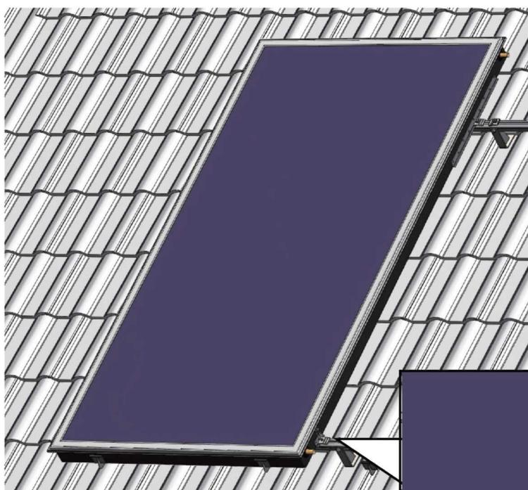
На болт надеть зажим коллектора (3), концом зажима фиксируя бок коллектора, после чего на болт надеть круглую прокладку, зубчатую прокладку и легко закрутить гайку, оставляя возможность корректировки положения коллектора.
