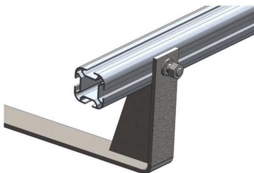
Затем разместить крепежные болты (6) в отверстиях кронштейна (2) и легко прикрутить гайки.
