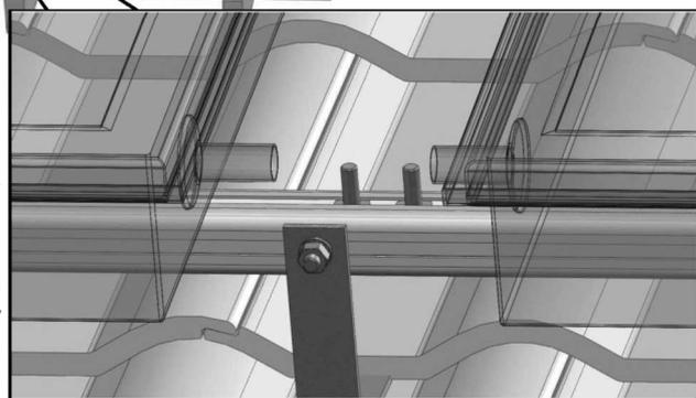
коллектора (3) на этом этапе монтажа можно пропустить и замонтировать уже после установки солнечных коллекторов, а крепежные болты, которые монтируются между коллекторами, устанавливаем симметрично относительно центра профиля, сохраняя между ними расстояние около 1130 мм.
