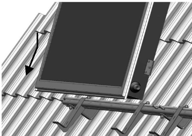
Для этого следует нижнюю грань коллектора опереть на нижнем профиле (1). Осторожно ссунуть его вниз до момента опора на двух держателях (4), после чего положить коллектор на верхний профиль (1).
